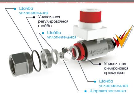
Технология TEFLOSIL от Germany Engineering Group Ltd. для ультрамягкого хода шаровой заслонки. Инновационное решение механизма шаровой заслонки с двумя тефлоновыми и одной пружинящей силиконовой прокладкой обеспечивают минимальное трение и, соответственно, мизерные потери мощности редуктора на трении.
