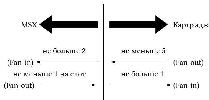
Рисунок 1.33. Fan-in и Fan-out для сигналов шин адреса и данных.
