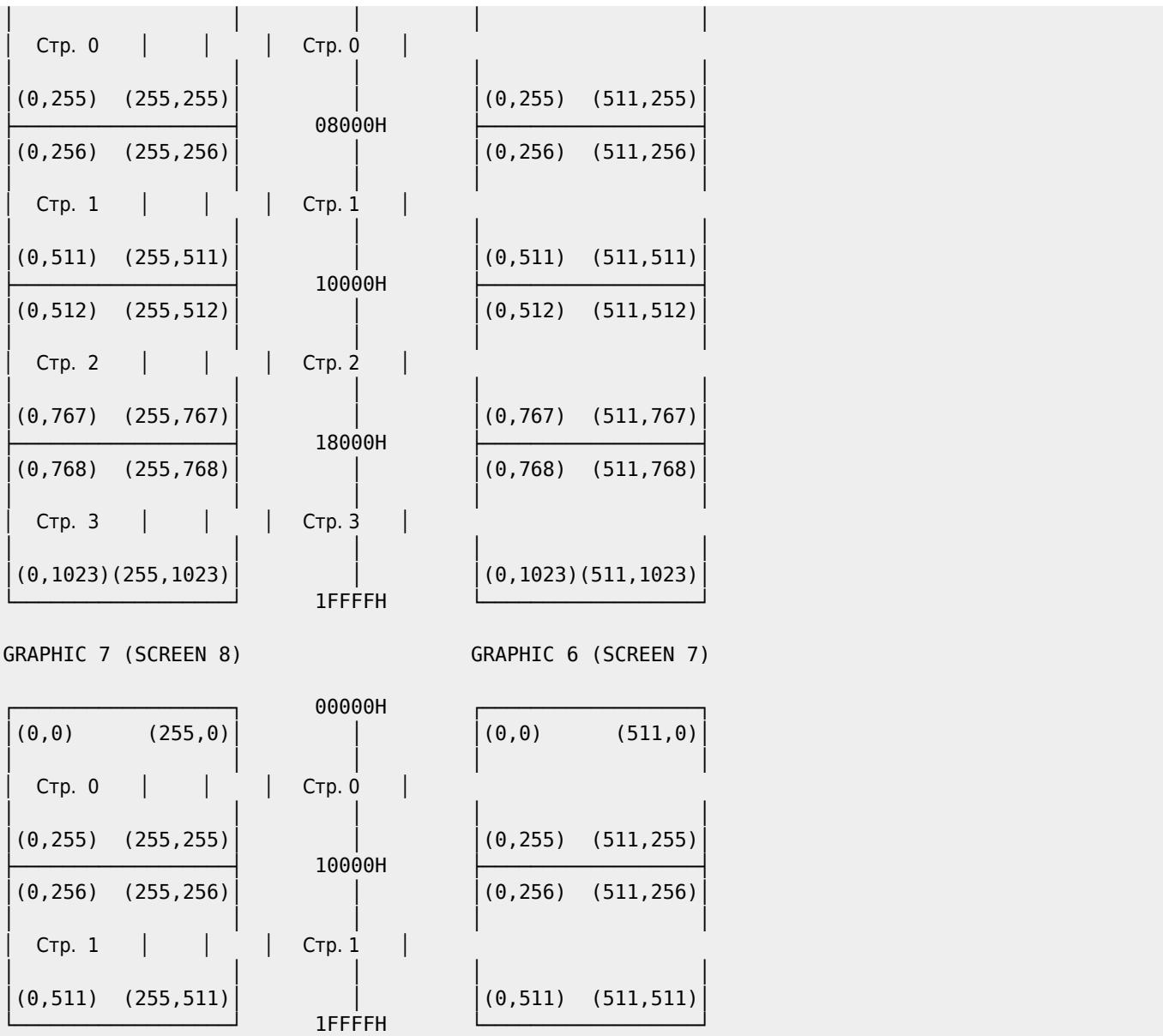
Рис.19.1. Координатная система VRAM
