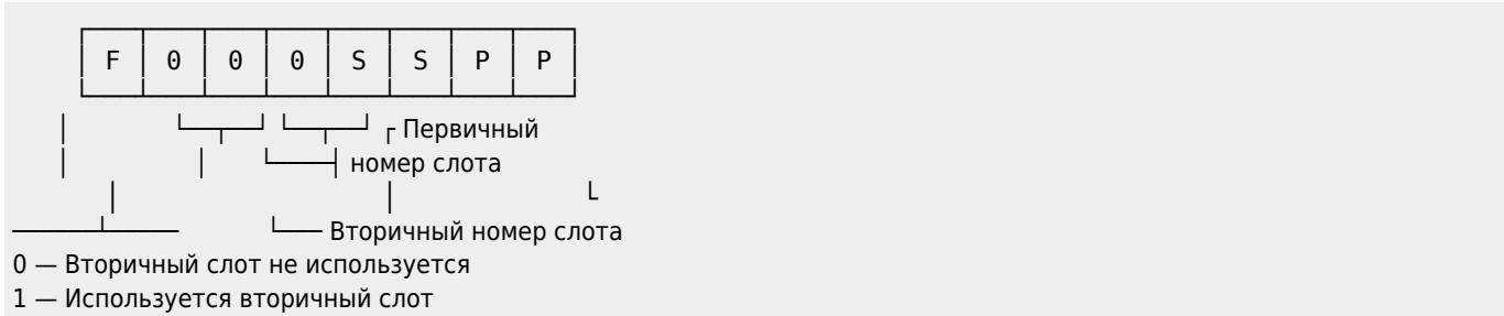
При межслотовом вызове CALSLT и CALLF прерывания автоматически запрещаются. При возврате управления из этих подпрограмм в MSX-1 прерывания остаются запрещёнными, а в MSX-2 восстанавливается статус прерываний, который был установлен до вызова подпрограмм. Например,
